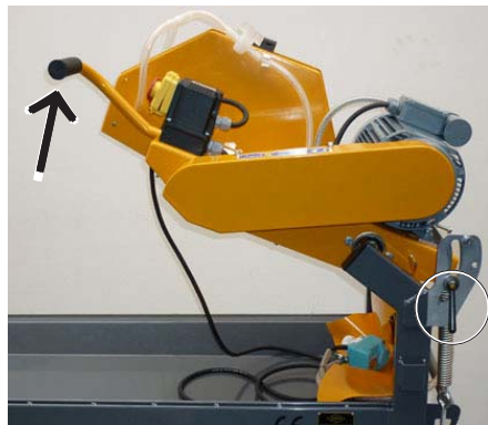
Рис. 4.8, Режущий рычаг макс. поднят вверх и зафиксирован зажимным рычагом
