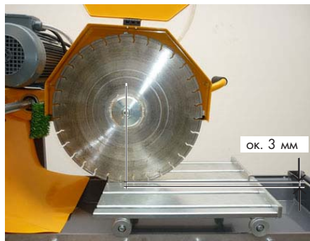
Рис. 4.28, Качающийся рукав (Диск опущен на полную глубину резки)
