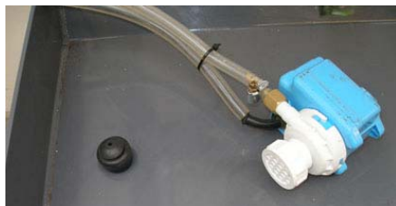
Рис. 4.14 , Водяной насос в ванне, сливное отверстие ванны закрыто резиновой заглушкой
