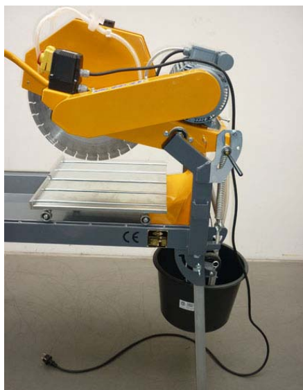
Рис. 4.33, Сетевой кабель 230 Вольт проложен к CTS • 175.1
