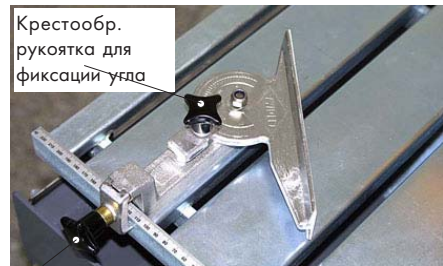
Рис. 4.39, Дополнительный регулируемый угловой упор смонтирован на роликовом столе
