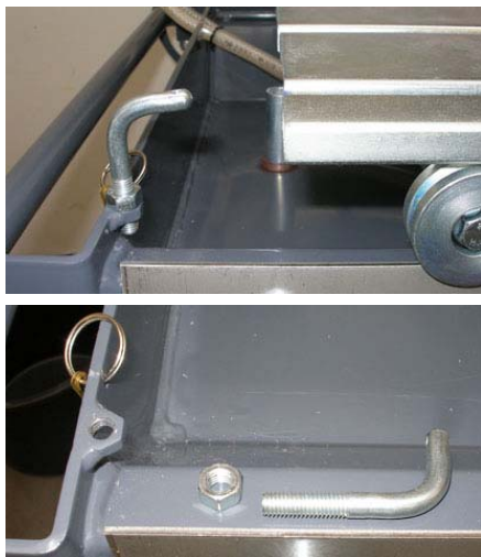
Рис. 5.6. Транспортный фиксатор роликового стола, смонтирован, снят
