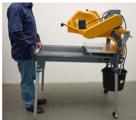
Рис. 5.17, CTS • 175.1, транспортировка на опорных ножках с смонтированными транспортными роликами
