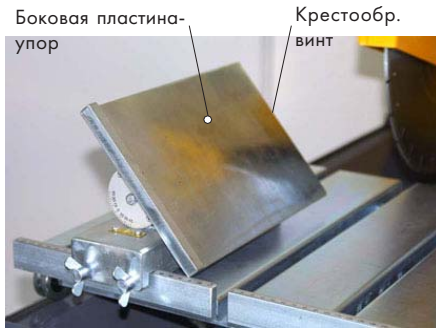
Рис. 4.37, Дополнительный стол JOLLY смонтирован на роликовом столе
