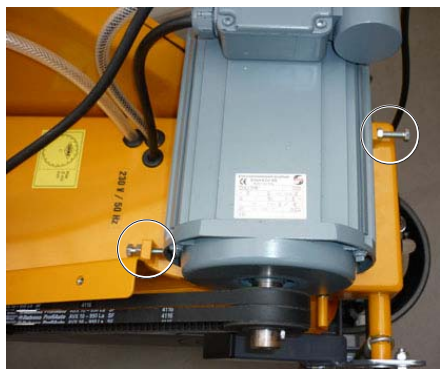
Рис. 5.11. Натяжные винты на подножке двигателя привода диска
