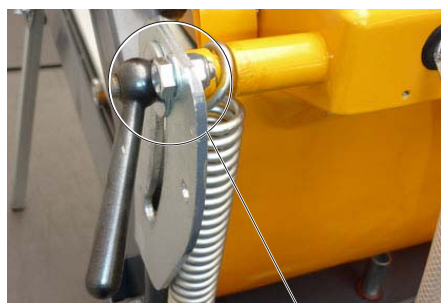
Рис. 4.28, Качающийся рукав (Диск опущен на полную глубину резки)
