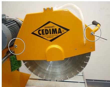
Рис. 4.27, Режущий диск смонтирован, крышка защитного кожуха диска закрыта и зафиксирована круглыми гайками
