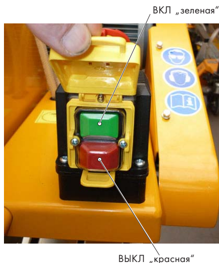
Рис. 4.34. Комбинированный аварийный и главный выключатель CTS • 175.1, крышка открыта
