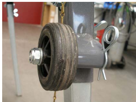
Рис. 5.19, Транспортный ролик смонтирован на раме настольной пилы
