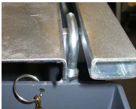
Рис. 5.7. Зажимной болт транспортного фиксатора выровнен на роликовый стол
