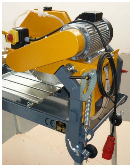
Рис. 4.32, Сетевой кабель 400 Вольт проложен на CTS • 175.1
