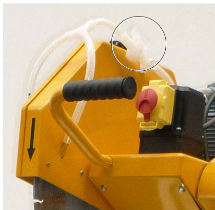
Рис. 4.16, Регулирующий запорный кран и подача воды с двух сторон к режущему диску
