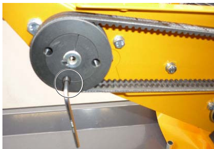
Рис. 5.13, Завинчивание штифтового болта в третье отверстие и выдавливание замыкающей (зажимной) втулки
