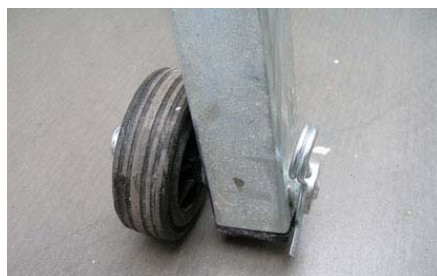
Рис. 5.16, Смонтированный транспортный ролик на опорной ножке
