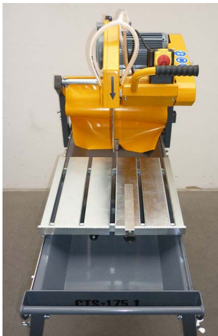
Рис. 4.36, место оператора, вид с места оператора на настольную пилу CTS • 175.1
