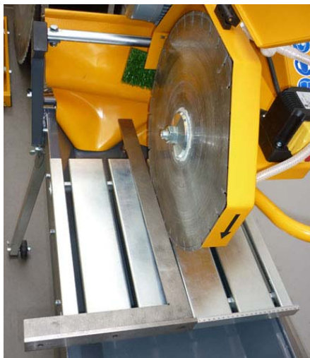
Рис. 5.5. Проверьте горизонтальный угол ° между режущим диском и роликовым столом
