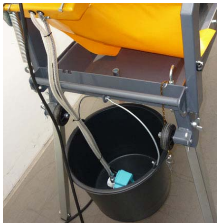
Рис. 4.15, Водяной насос в ведре, заглушка в сливном отверстии ванны
