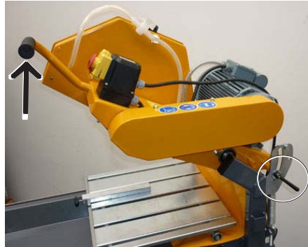
Рис. 4.18, Режущий рычаг поднять вверх и зафиксировать зажимным рычагом
