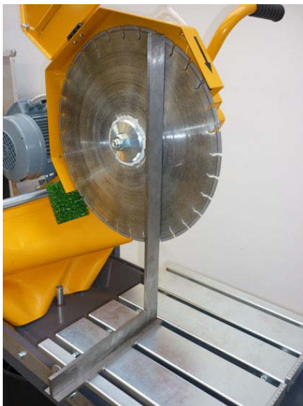
Рис. 5.1, Проверка вертикального угла 90° между режущим диском и роликовым столом
