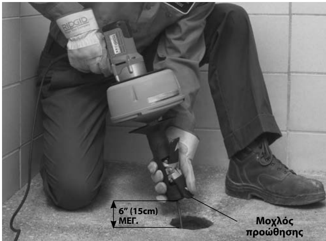
Εικόνα 10 – Προώθηση του σπιράλ με AUTOFEED
