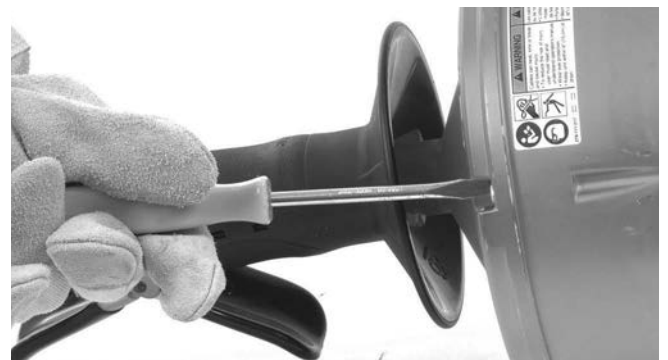
Figur 13 – Lossa fyra (4) trumskruvar cirka tre (3) hela varv men ta inte bort dem
