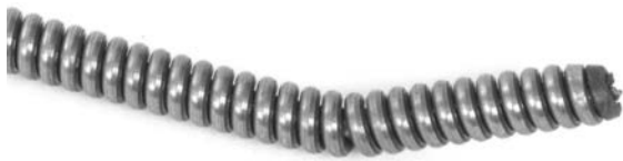
Figura 15 – Cable curvado a una pulgada de su término
