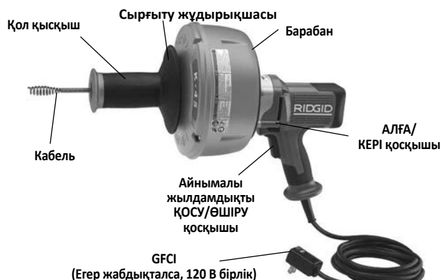
1-сурет – Сырғыту жұдырықшасы бар К-45 ағын құбырын тазалау құрылғысы
