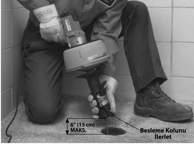
Şekil 10 – Kablonun AUTOFEED İle Beslenmesi
