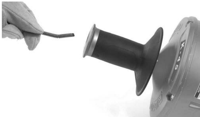
Figur 17 – Ladda spiral utan att byta innertrumman
