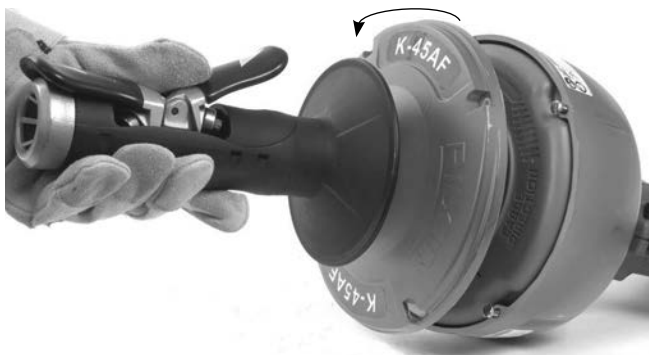
Figura 14 – Girare il tamburo in senso antiorario
