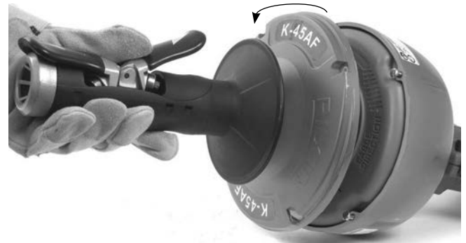
Figuur 14 – Draai het deksel van de trommel
