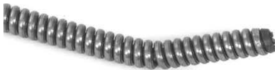
Рис. 15 – Изгиб на конце троса
