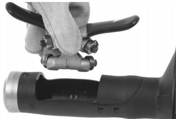
Abbildung 12B – Entfernen des AUTOFEED Mechanismus aus dem Gehäuse
