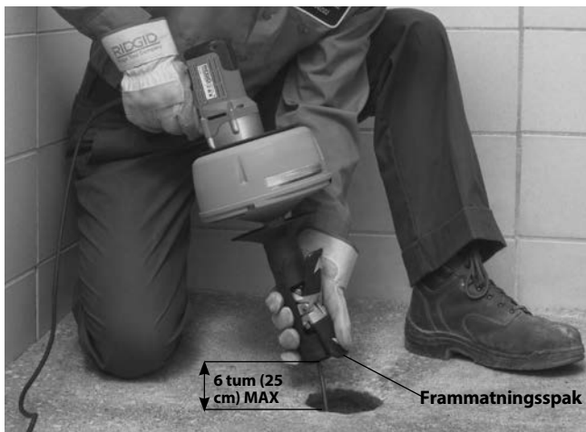
Figur 10 – Mata spiral med AUTOFEED
