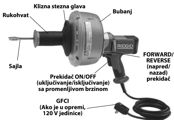
Slika 1 – K-45 Mašina za čišćenje odvoda sa kliznom steznom glavom
