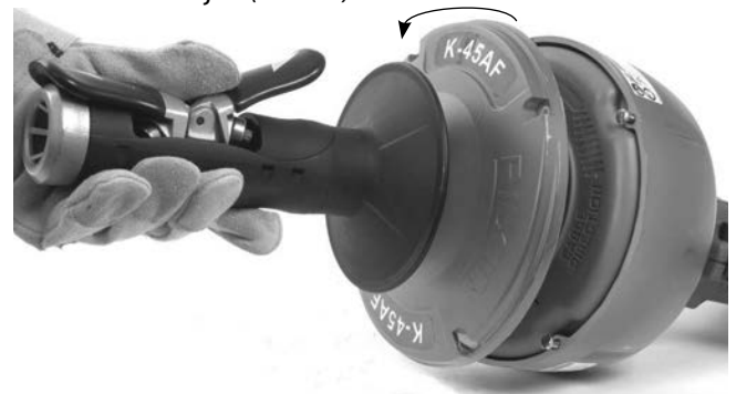
Slika 14 – Zakretanje odvojenog bubnja
