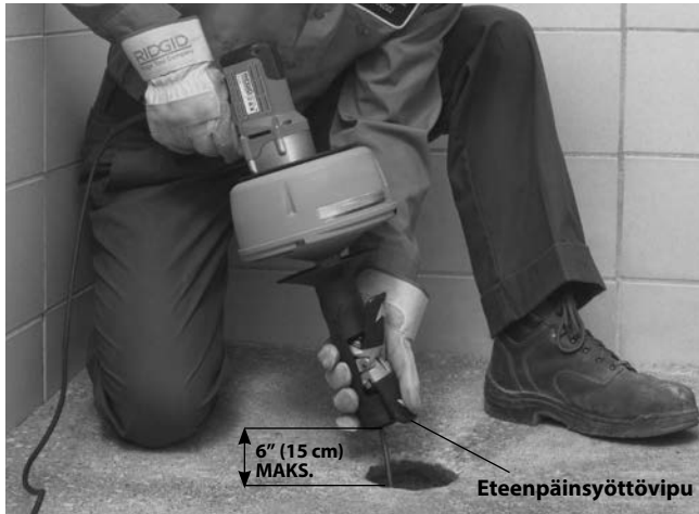
Kuva 10 – Jousen syöttäminen automaattisyötöllä
