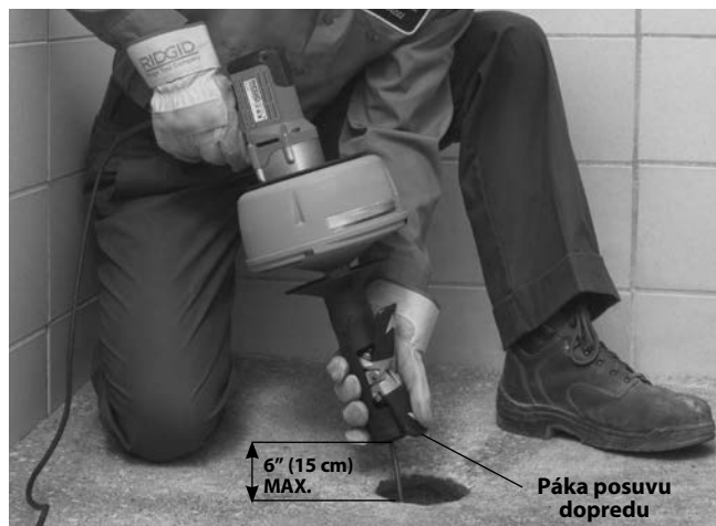
Obrázok 10 – Zavádzanie kábla pomocou funkcie AUTOFEED
