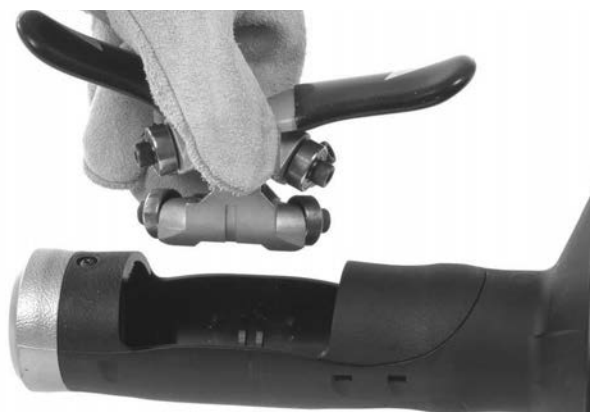
Obrázok 12B – Demontáž mechanizmu AUTOFEED z puzdra
