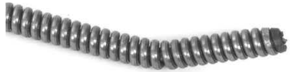
Abbildung 15 – Biegung am Spiralenende
