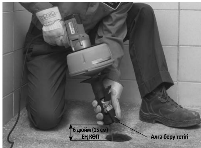
10-сурет – Кабельді AUTOFEED (АВТОМАТТЫ БЕРУ) арқылы беру
