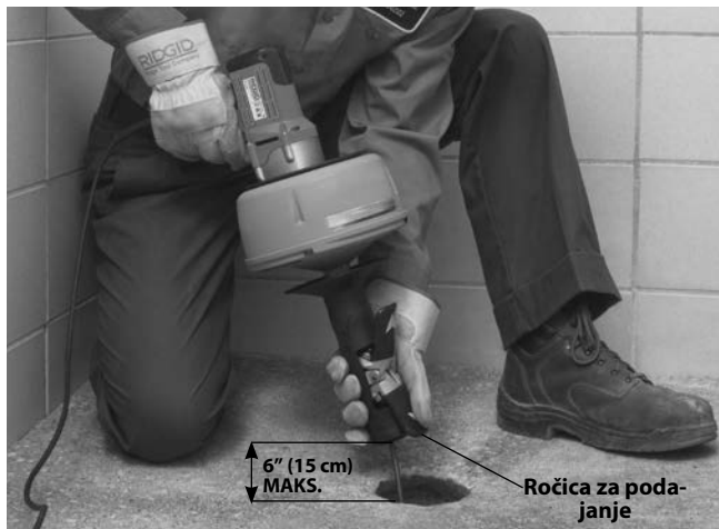
Slika 10 – Podajanje kabla skozi podajalnik AUTOFEED
