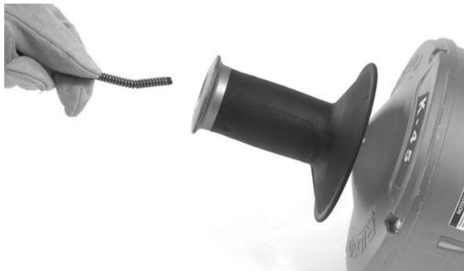
Slika 17 – Vstavljanje kabla brez menjave notranjega bobna
