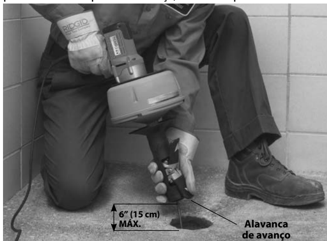
Figura 10 – Avançar o cabo com AUTOFEED
