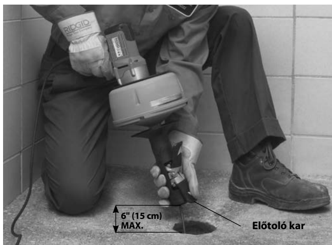
10. ábra – A kábel előtolása az AUTOFEED funkcióval
