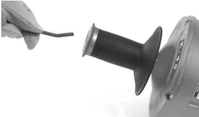
Εικόνα 17 – Τοποθέτηση σπιράλ χωρίς αλλαγή του εσωτερικού τύμπανου
