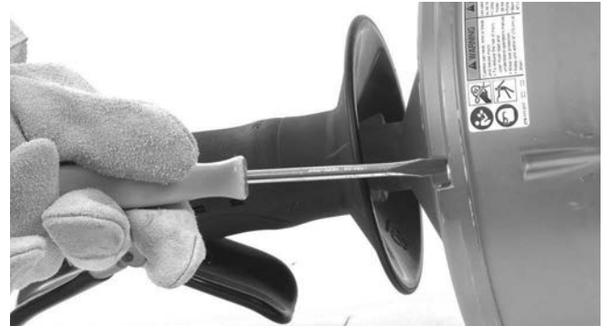
Slika 13 – 4 vijake bobna popustite za približno 3 polne obrate, vendar jih ne odstranite
