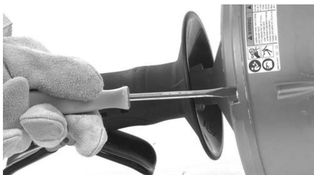
Rysunek 13 – Poluzować 4 śruby bębna o około 3 pełne obroty, ale nie wyjmować
