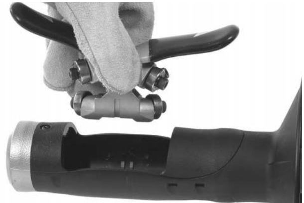
Figur 12B – Ta bort AUTOFEED-mekanismen från huset
