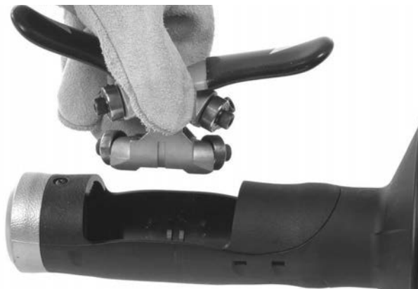
Slika 12B – Odstranjevanje mehanizma AUTOFEED iz ohišja
