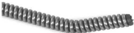
Slika 15 – Upogib na koncu kabla
