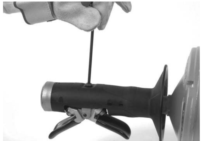
Abbildung 12A – Entfernen der AUTOFEED Schraube
