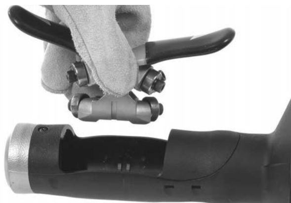
Рис. 12В – Снятие с корпуса устройства автоподачи AUTOFEED
