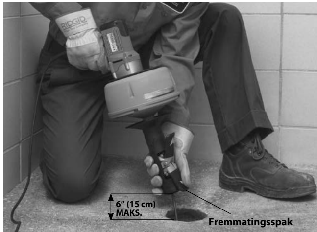
Figur 10 – Mating av kabel med AUTOFEED
