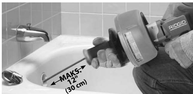
Figur 8 – Flytning af håndgrebet mod tromlen for at gribe spiralen med patronen
