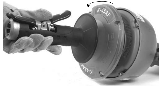
Slika 14 – Boben odprite z vrtenjem
