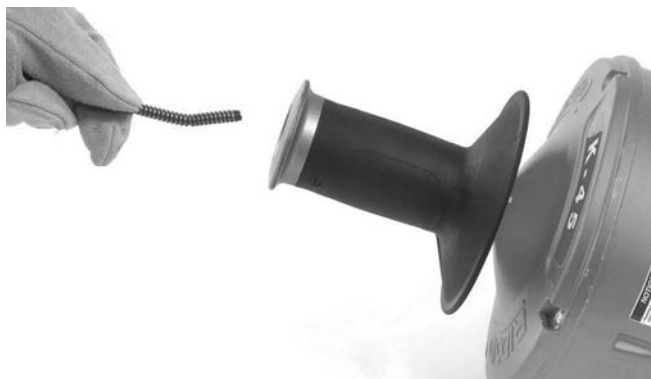
Slika 17 – Uvlačenje sajle bez zamjene unutarnjeg bubnja
