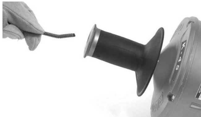
Figura 17 – Caricamento del cavo senza sostituire il tamburo interno
