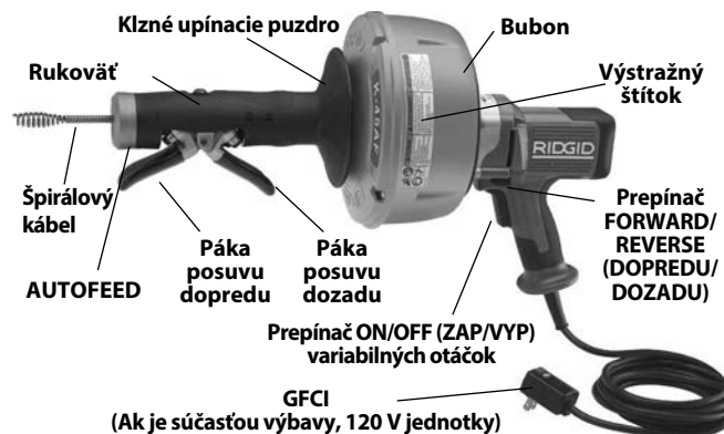
Obrázok 2 – Čistička odtokov K-45 AF s funkciou AUTOFEED
