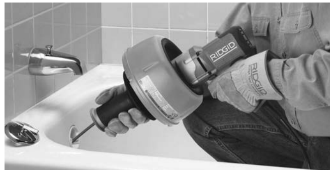
Εικόνα 9 – Ωθήστε το σπιράλ μέσα στον αγωγό αποχέτευσης
