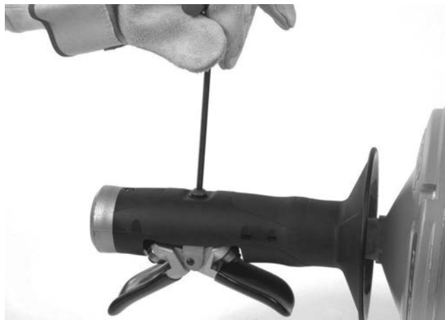
Рис. 12А – Отворачивание винта крепления устройства автоподачи AUTOFEED
