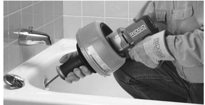
Şekil 9 - Spiral Kanal Hattına İtin
