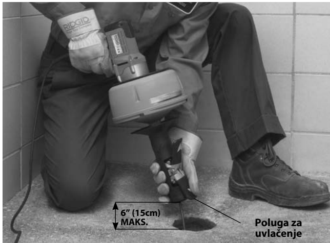
Slika 10 – Uvlačenje sajle kroz sustav AUTOFEED
