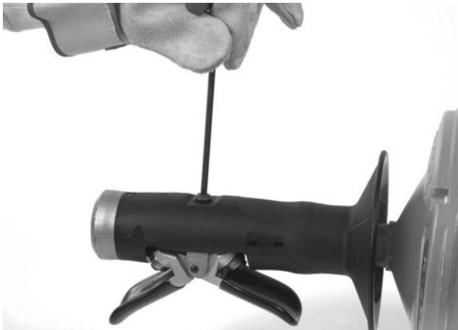
Figuur 12A – Verwijderen van de AUTOFEED-schroef
