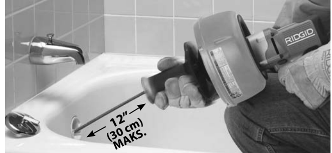
Şekil 8 - Kabloyu Mandrenle Kavramak için Tutamağı Makaraya Yaklaştırın
