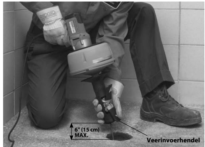
Figuur 10 – Veer invoeren met AUTOFEED
