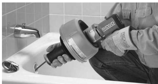
Rysunek 9 – Wpychać sprężynę do odpływu
