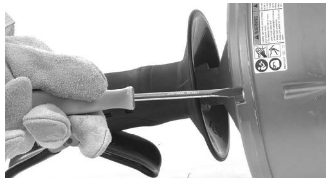
Slika 13 – Otpustite 4 vijka bubnja za oko 3 puna okretaja, ali ih nemojte uklanjati
