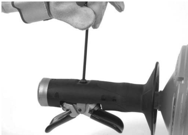
Slika 12A – Skidanje AUTOFEED vijka
