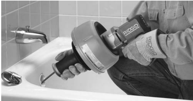
Figur 9 – Skub af spiralen ned i afløbsrøret
