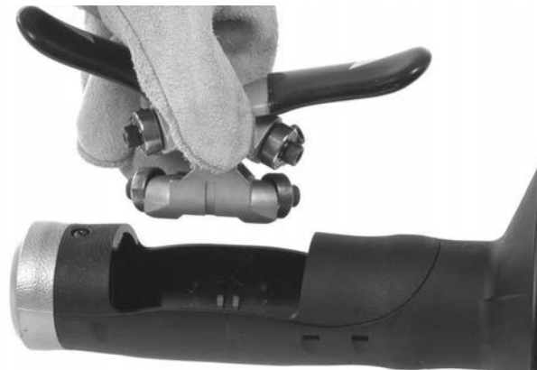
12B ábra – Az AUTOFEED mechanizmus kiserelése a tokozásból
