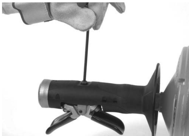
Obrázek 12A - Odšroubování šroubu AUTOPOSUVU
