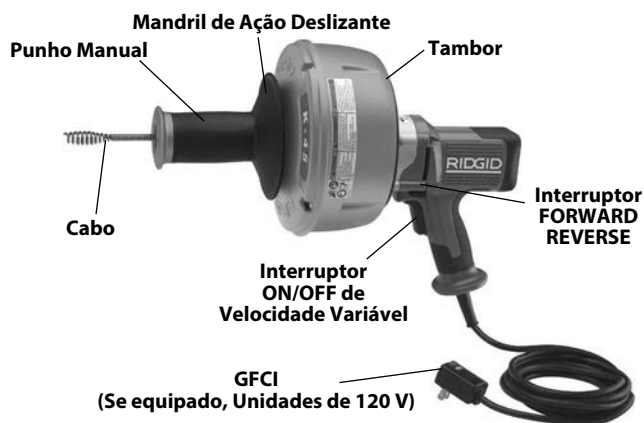
Figura 1 Máquina de Limpeza de Tubagens K-45 Com Mandril de Ação Deslizante
