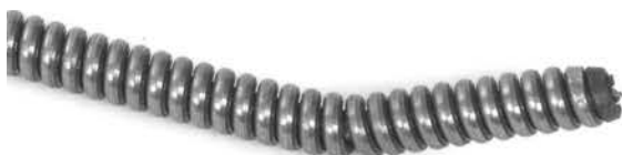
15. ábra – Megtörés a kábelvégnél
