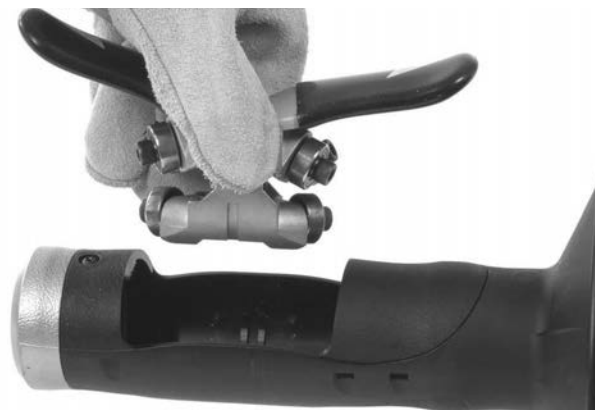
Figura 12B – Retirar o Mecanismo AUTOFEED do Alojamento
