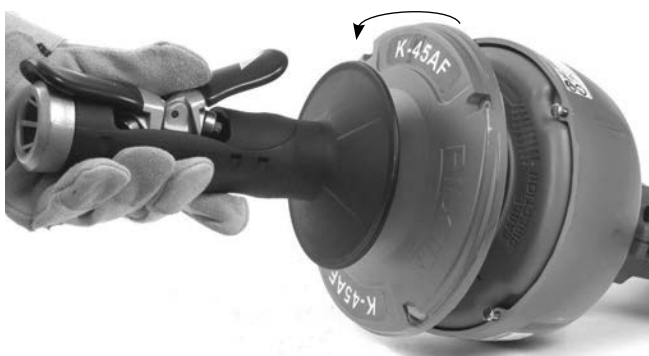
14. ábra – A dob szétcsavarása
