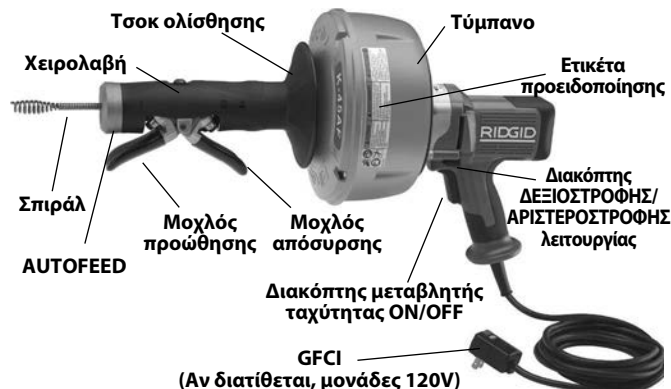
Εικόνα 2 – Μηχάνημα απόφραξης αποχετεύσεων K-45 AF με AUTOFEED
