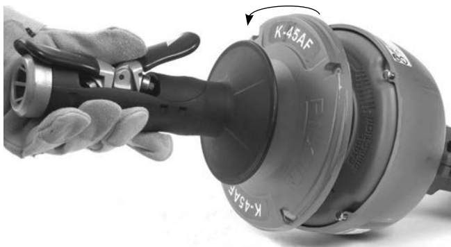
Figura 14 – Desfacerea tamburului prin răsucire
