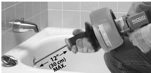
Figura 8 – Deslocar o punho na direção do tambor agarrar o cabo com o mandril.
