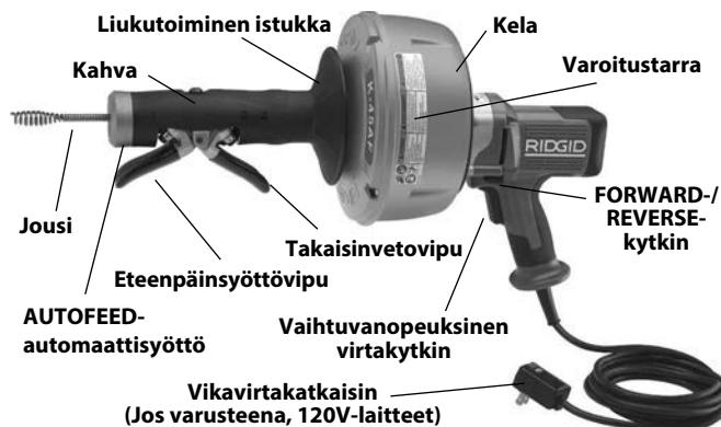
Kuva 2 – K-45 AF Viemärinavaaja AUTOFEED-automaattisyötöllä
