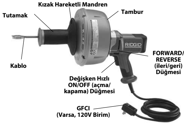
Şekil 1 - Kızık Hareketli Mandreni olan K-45 Kanal Temizleme Makinesi
