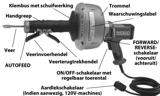
Figuur 2 – K-45 AF Afvoertopstoper met automatische veertoevoer (AUTOFEED®)
