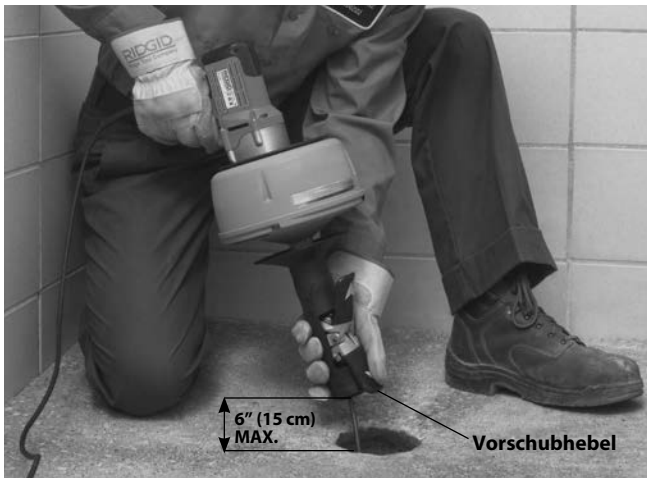
Abbildung 10 – Vorwärtsschieben der Spirale mit AUTOFEED
