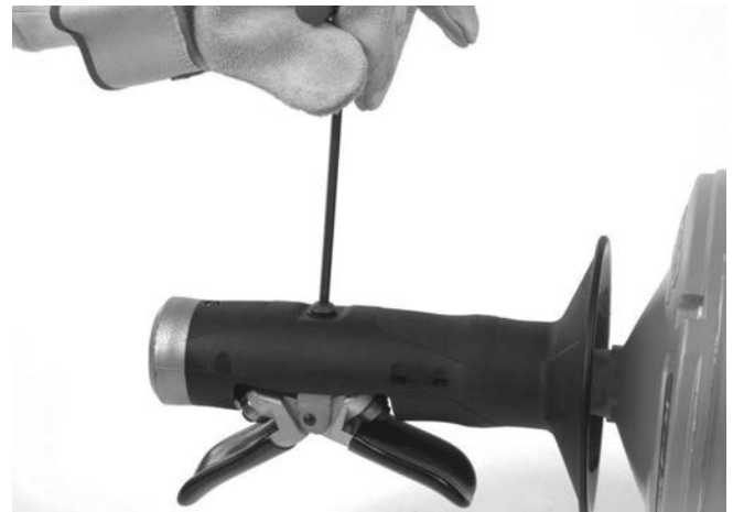
Figur 12A – Fjernelse af AUTOFEED-skruen
