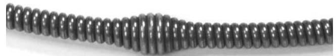
Obrázek 11 – Kabel C-13-IC SB s indikací konce kabelu pomocí „retardéru“ je přibližně 84" (2,1 m) od konce kabelu
