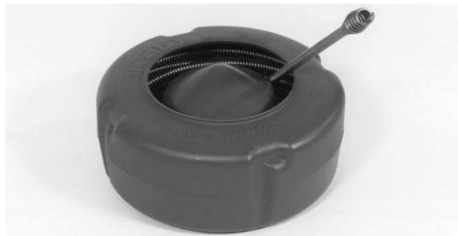
Rysunek 16 – Ładując sprężynę do wewnętrznego bębna, zwinąć ją W PRAWO
