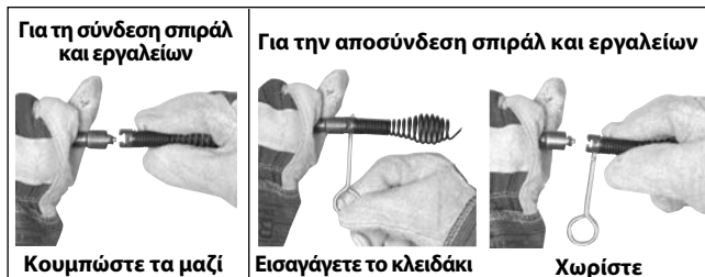
Εικόνα 7 – Σύνδεση και αποσύνδεση εργαλείων
