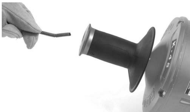
17-сурет – Ішкі барабанды ауыстырмай кабельді салу
