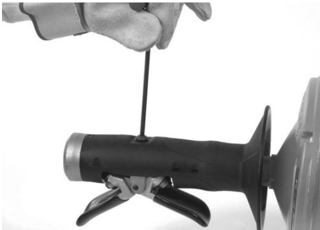
Figur 12A – Fjerning av AUTOFEED-skrue
