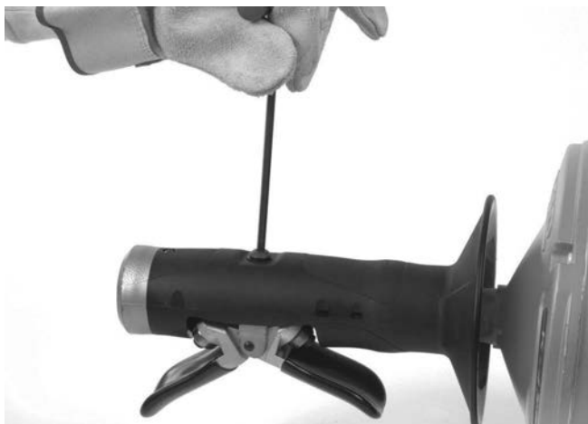
12A ábra – Az AUTOFEED csavar eltávolítása
