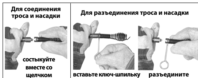
Рис. 7 – Подсоединение и отсоединение насадок
