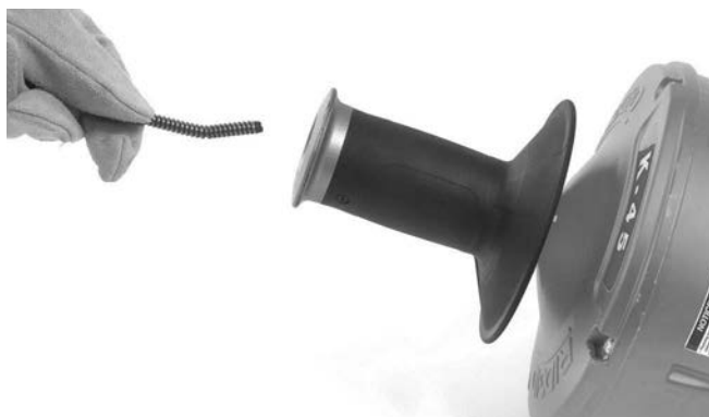
Obrázok 17 – Zavedenie kábla bez výmeny vnútorného bubna
