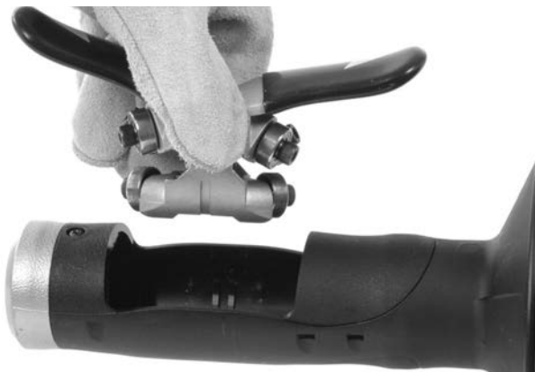
Figura 12B – Extracción del mecanismo de la AUTOFEED
