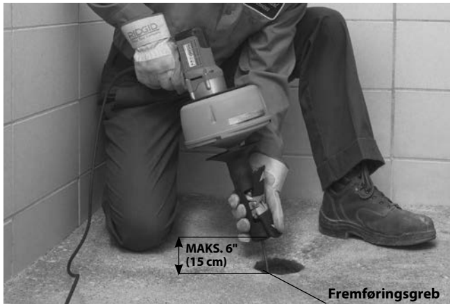
Figur 10 – Fremføring af spiral med AUTOFEED
