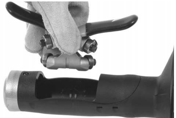
Εικόνα 12Β – Αφαίρεση μηχανισμού AUTOFEED από το περίβλημα
