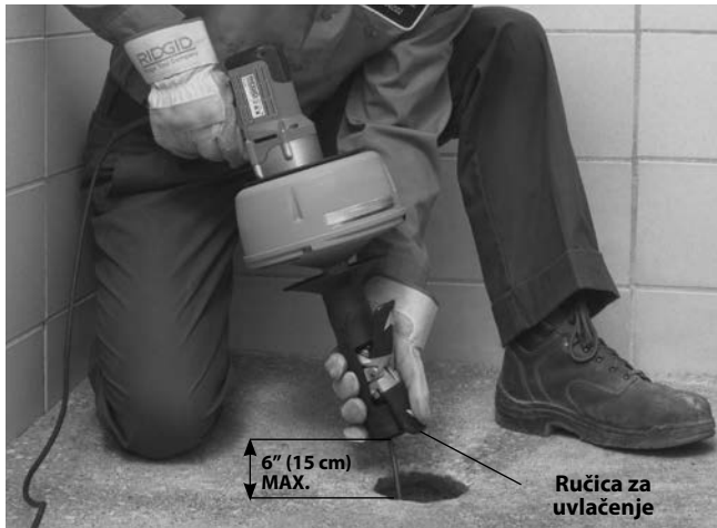
Slika 10 – Sprovođenje sajle sa AUTOFEED
