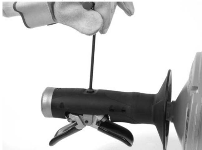
Figure 12A – Retrait de la vis de l'AUTOFEED
