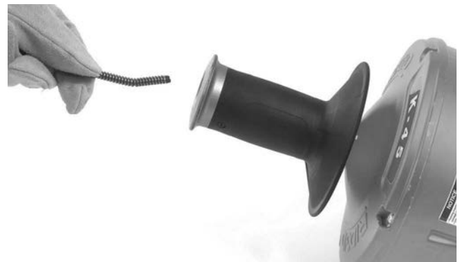
Abbildung 17 – Einlegen der Spirale ohne Wechsel der Innentrommel
