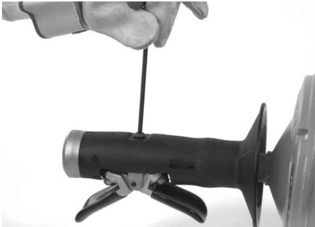
Kuva 12A – AUTOFEED-ruuvin irrottaminen
