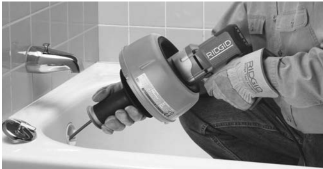
Obrázek 9 - Zasunujte kabel dolů do odpadového potrubí
