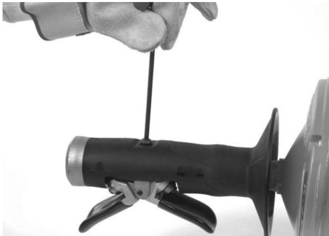
Slika 12A – Skidanje AUTOFEED zavrtnja
