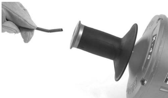
Slika 17 – Uvlačenje sajle bez zamene unutrašnjeg bubnja
