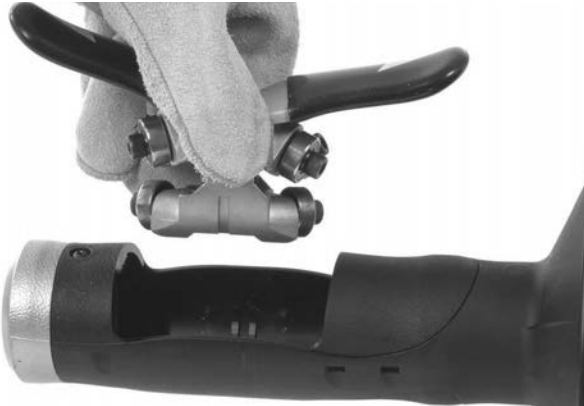
Şekil 12B - AUTOFEED Mekanizmasının Muhafazadan Çıkartılması
