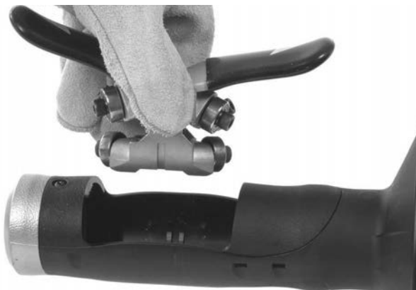
Slika 12B – Skidanje AUTOFEED mehanizma sa kućišta
