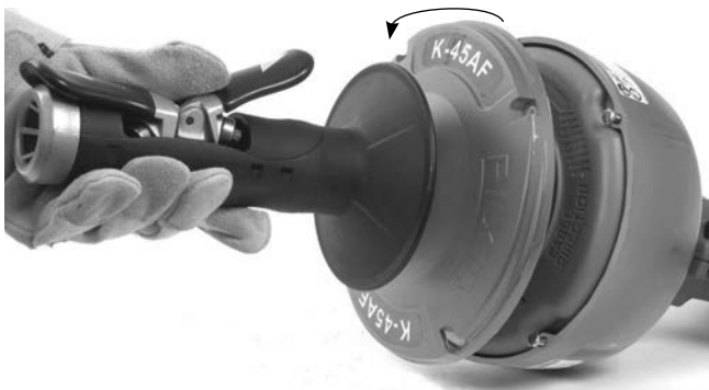
Abbildung 14 – Auseinanderdrehen der Trommel
