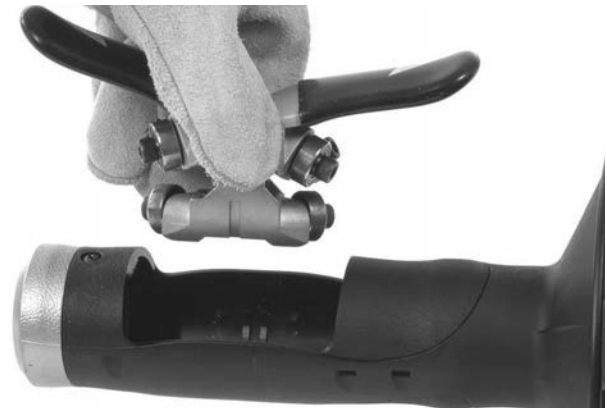
Figur 12B – Afmontering af AUTOFEED-mekanismen fra huset
