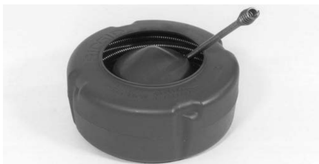
Slika 16 – Kada uvlačite sajlu u unutrašnji bubanj, namotavajte sajlu u SMERU KAZALJKE
