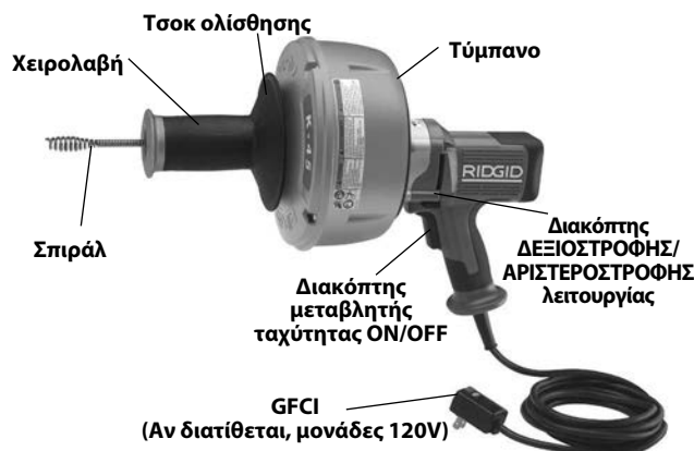
Εικόνα 1 – Μηχάνημα απόφραξης αποχετεύσεων με τσοκ ολίσθησης K-45
