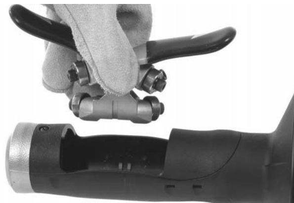
Obrázek 12B – Vyjímání mechanismu AUTOPOSUVU ze skříně
