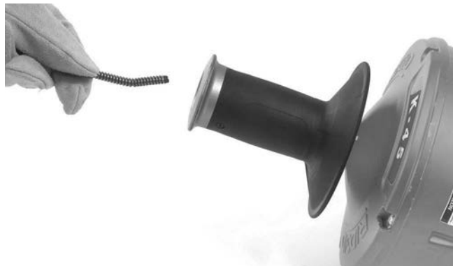
Obrázek 17 – Navíjení kabelu bez výměny vnitřního bubnu
