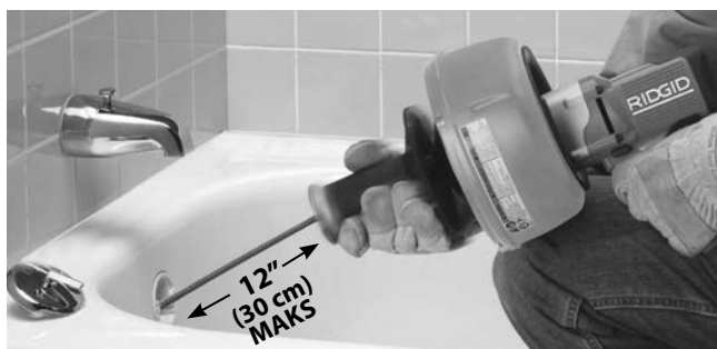
Figur 8 – Flytt håndtaket mot trommelen for å ta tak i kabelen med kjoksen
