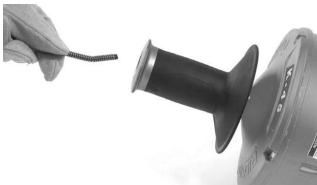
Kuva 17 – Jousen lataaminen vaihtamatta sisäkela
