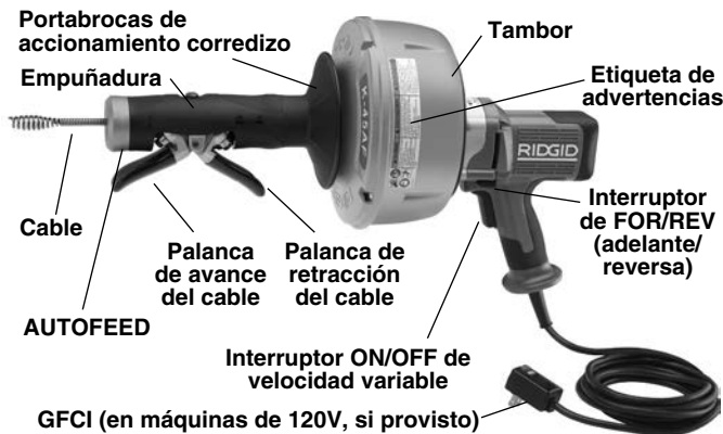
Figura 2 – Limpiadora de desagües K-45 AF con AUTOFEED
