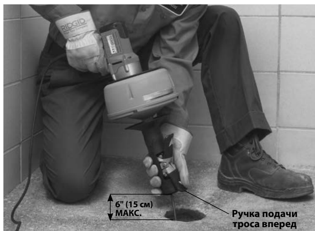
Рис. 10 – Подача троса с помощью устройства AUTOFEED
