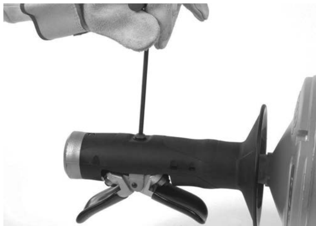
Figura 12A – Retirar o Parafuso AUTOFEED
