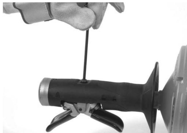
Figura 12A – Demontarea șurubului AUTOFEED
