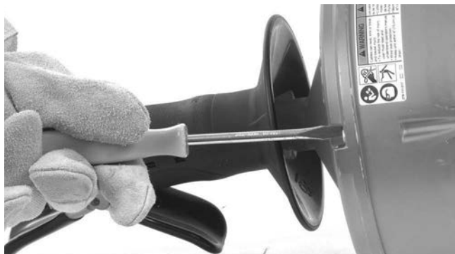
13-сурет – 4 барабан бұрандасын шамамен 3 толық айналым босату, бірақ алып тастамау
