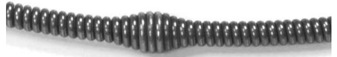
Şekil 11 – C-13-IC SB Kablo Ucu Göstergesi Hız tümseği Bulunan Kablo Kablonun Ucundan Yaklaşık 84" (2,1 m)
