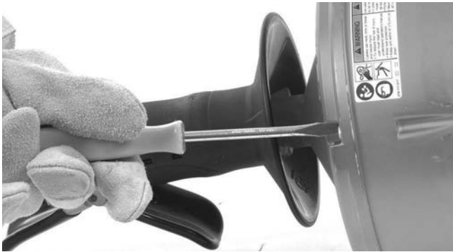
Abbildung 13 – 4 Trommelschrauben etwa 3 Umdrehungen lösen, aber nicht entfernen
