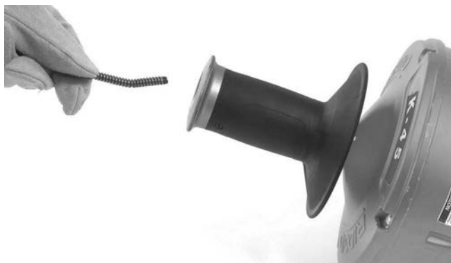
Figur 17 – Lasting av kabel uten å skifte innertrommel
