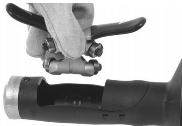
Figura 12B – Rimozione del meccanismo AUTOFEED dall'alloggiamento
