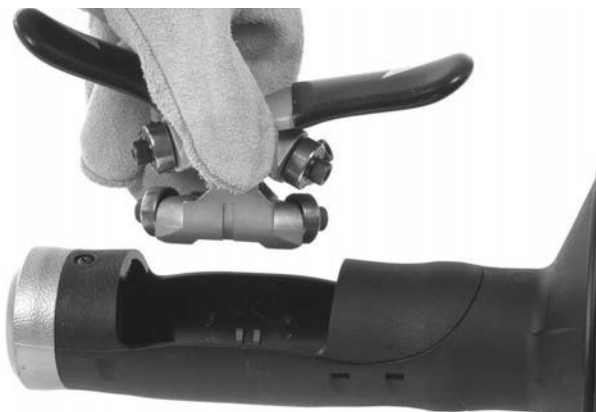
Rysunek 12B – Wymontowanie mechanizmu AUTOFEED z obudowy
