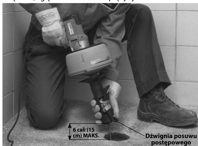
Rys. 10 – Wprowadzanie sprężyny za pomocą mechanizmu autoposuwu AUTOFEED
