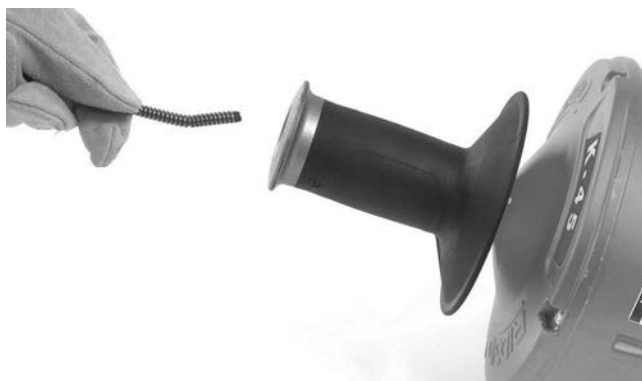
Figur 17 – Indføring af spiral uden skift af indertromlen
