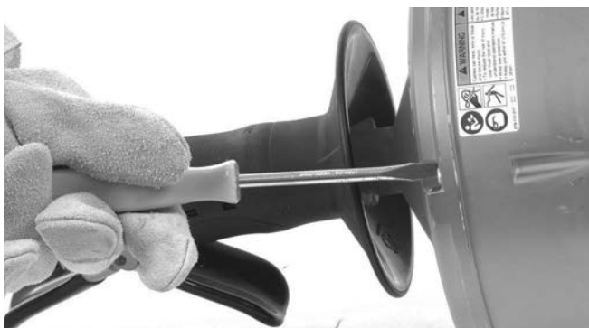
Figur 13 – Løsning af de 4 tromleskruer ca. 3 hele omdrejninger uden at fjerne dem
