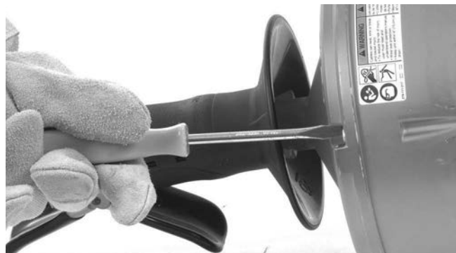
Figura 13 – Desaperte os 4 parafusos do tambor cerca de 3 voltas completas, mas sem os retirar
