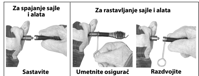
Slika 7 - Spajanje i odvajanje alata
