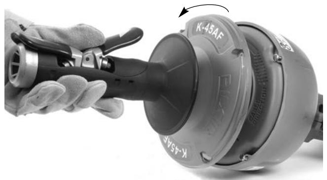
Figura 14 – Apertura de la tapa del tambor exterior
