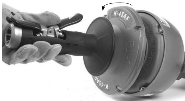
Rysunek 14 – Rozkręcić bęben
