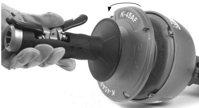
Figur 14 – Tromlens dele drejes fra hinanden
