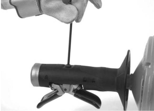
Şekil 12A - AUTOFEED Vidasının Çıkartılması
