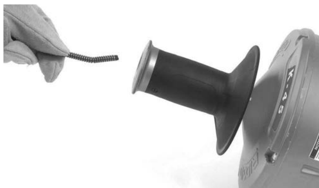
Рис. 17 – Заправка троса без замены внутреннего барабана
