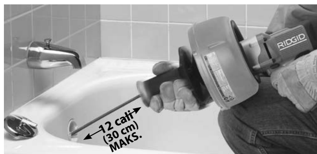
Rysunek 8 – Przesunąć rączkę do bębna w celu złapania sprężyny chwytakiem
