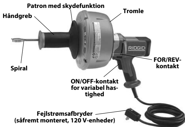
Figur 1 – K-45 Afløbsrensemaskine med patron med skydefunktion
