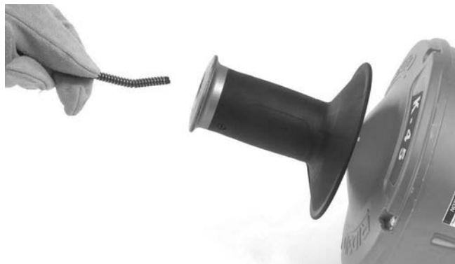
Rysunek 17 – Ładowanie sprężyny bez wymiany wewnętrznego bębna
