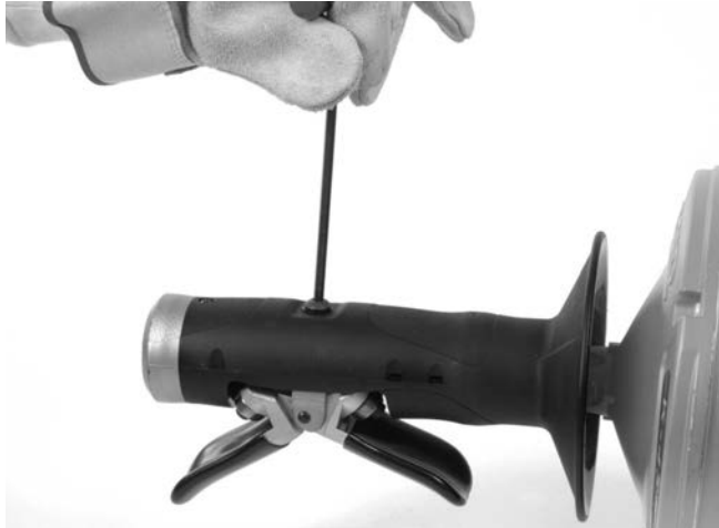
Figura 12A – Extracción del tornillo de la AUTOFEED
