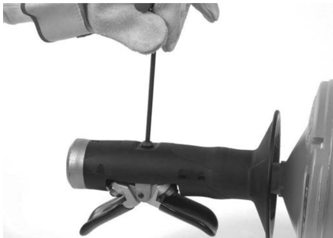
Rysunek 12A - Wykręcanie śruby mechanizmu AUTOFEED
