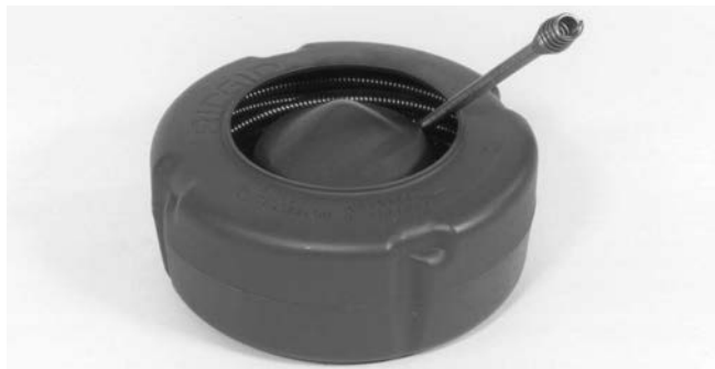
Figur 16 – Når du laster kabelen inn i en innertrommel, dreier du kabelen MED URVISEREN.
