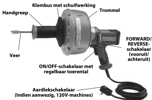
Figuur 1 – K-45 Afvoerontstoppingsmachine met klembus met schuifwerking
