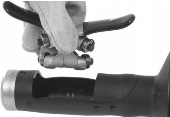
Kuva 12B – AUTOFEED-mekanismin irrottaminen kotelosta
