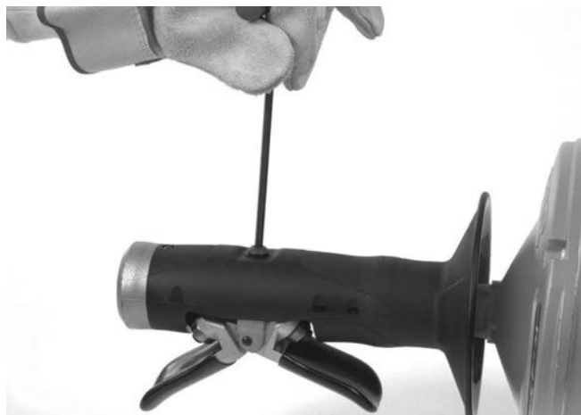
Figura 12A – Rimozione della vite AUTOFEED
