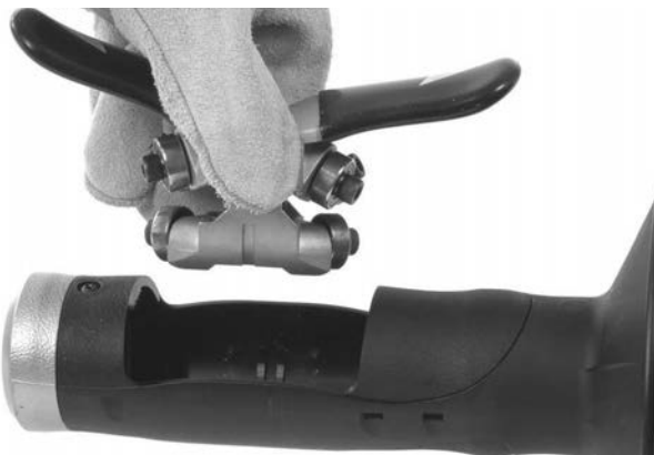
Figur 12B – Fjerning av AUTOFEED-mekanisme fra hus
