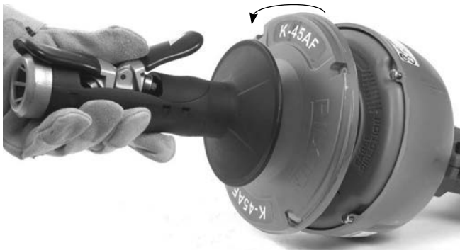
Рис. 14 – Проверните и разъедините крышки барабана
