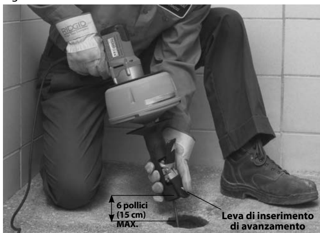
Figura 10 – Inserimento del cavo in modalità AUTOFEED
