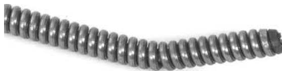
Figura 15 – Curbura de la capătul cablului
