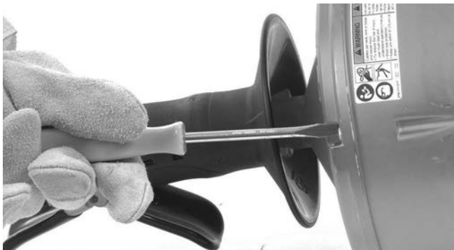
Figura 13 – Slăbiți cele 4 șuruburi de tambur cu circa 3 rotații complete, fără să le scoateți
