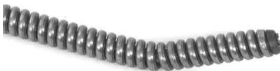
Figur 15 – Bøjning i spiralens ende
