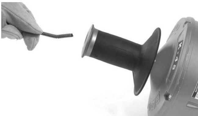
Figuur 17 – Veer laden zonder de binnentrommel te vervangen
