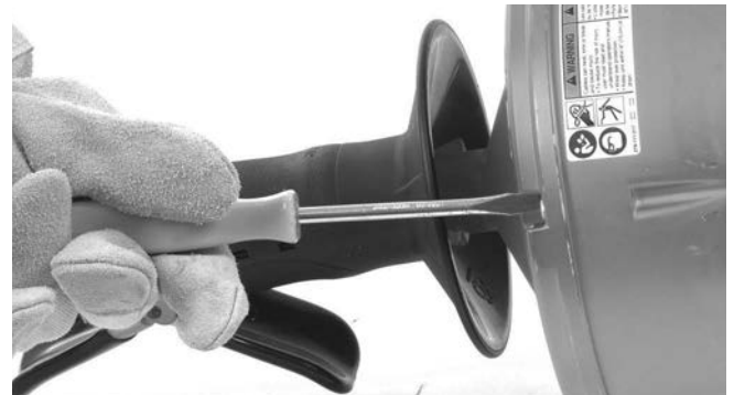
Figur 13 – Løsne 4 trommelskrue omtrent 3 hele omdreininger, men ikke fjern dem
