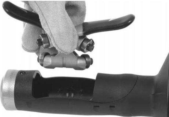
Figuur 12B – Verwijderen van het AUTOFEED-mechanisme uit behuizing
