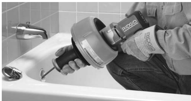
Figura 9 – Empurrar o cabo dentro da tubagem
