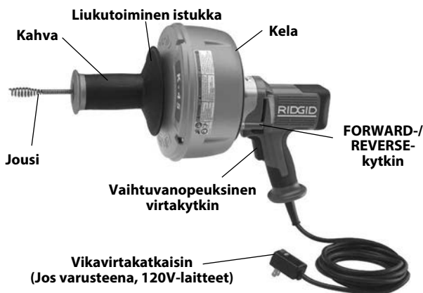
Kuva 1 – K-45 liukutoimisella istukalla varustettu viemärinavauslaite
